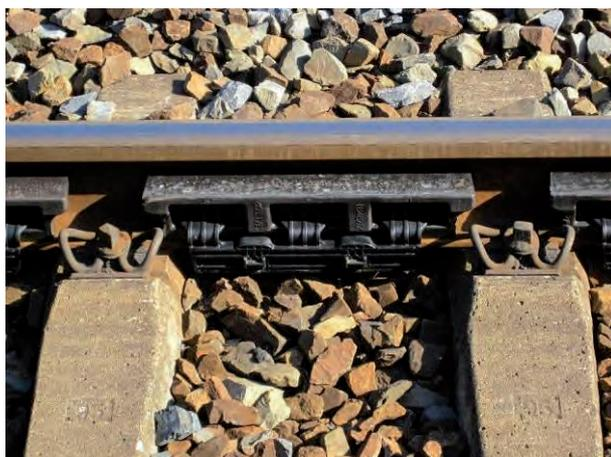
Bild 4: Beispielfoto für die Technologie Schienenstegdämpfer
